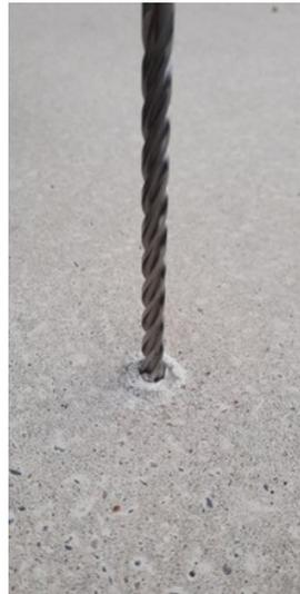
Forez la pyrite à l'aide d'une carotteuse, dia – 10-15 mm
