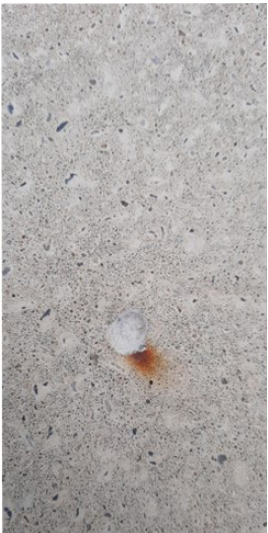
Zo ziet een uitgeboorde pyrietkern eruit; diepte varieert van 0,5cm - 2cm
