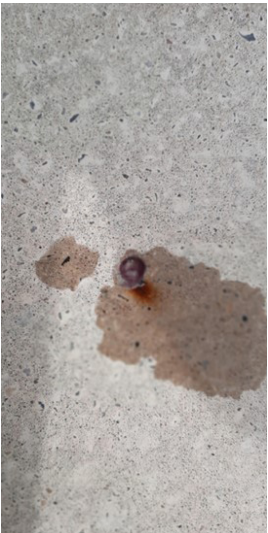
Lithofin Rost-Ex op ijzererts geeft een paars, bruisende reactie; opschuren met een spons en naspoelen met voldoende water
